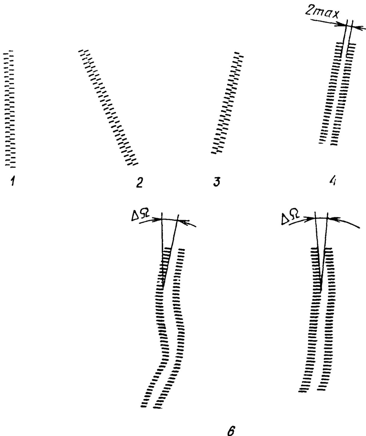
1, 2, 3—отсутствие дефектов; 4—импульсный камень смещен с линии центров «вилка—баланс» при нахождении системы «баланс—спираль» в положении статического равновесия; 6—система «баланс—спираль» неизохронна, периодически меняется амплитуда колебаний баланса;  $\Delta\Omega$ —изменение мгновенного хода.
