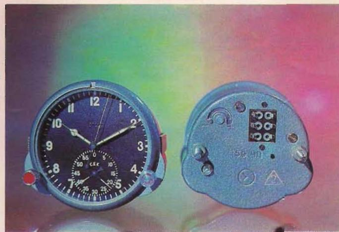
Часы предназначены для измерения в минутах и секундах коротких промежутков времени до 1 h и для показания текущего времени в часах, минутах и секундах. Часы состоят из механизмов текущего времени и секундомера. Секундомер может включаться и выключаться.
