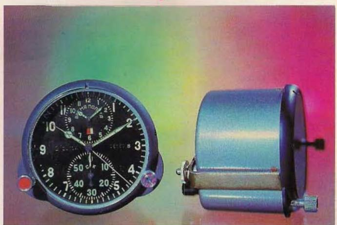
Часы предназначены для показания текущего времени в часах, минутах и секундах; для отсчета времени полета летательного аппарата в часах и минутах; для отсчета малых промежутков времени в минутах и секундах.
